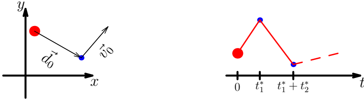
Рис. 4. Перехват одним перехватчиком. Красным цветом обозначен перехватчик, синим – цели
