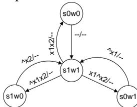
Рис. 7. Результирующий автомат сетевой модели RS-триггера
