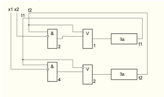
Рис.8. Структурная схема модели RS-триггера на задержках
