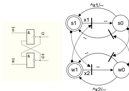
Рис. 6. Сетевая автоматная модель RS-триггера
