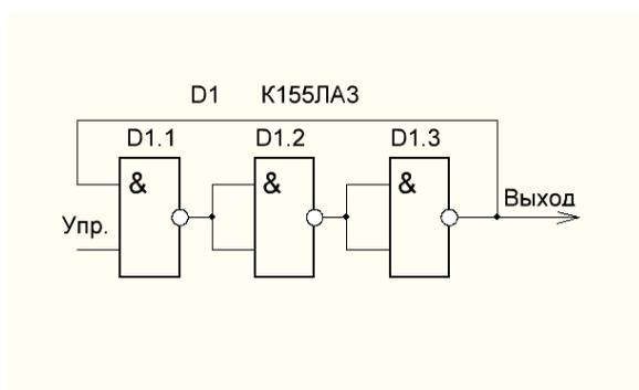
Рис. 2. Схема генератора на элементах И-НЕ
