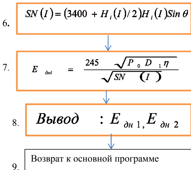
Рис. 5 Блок-схема подпрограммы “EDHI” - вычисления напряженности поля сигнала с учетом высоты ионосферы.
