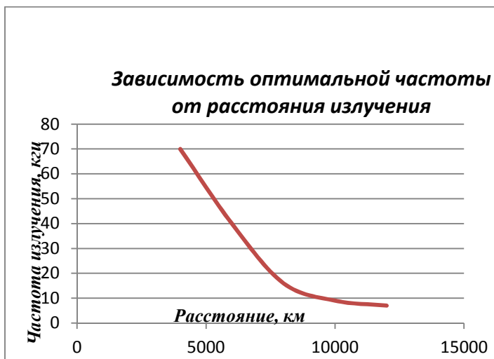
Рис.6 Зависимость оптимальной частоты несущей частоты волны от расстояния
