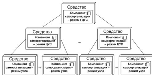
Рис. 4: Схема иерархической самоорганизующейся сети
