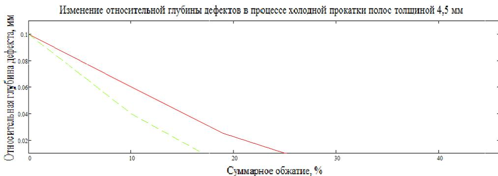
Рис. 7. Процесс выкатывания дефектов с относительной глубиной 0,1 мм при  $\mu=0,07$ , где красной линией обозначено изменение относительной глубины дефектов с конусообразной формой кратера, зеленой – с округлой
