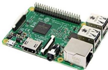
*Рис. 2. Микрокомпьютер Raspberry PI*
