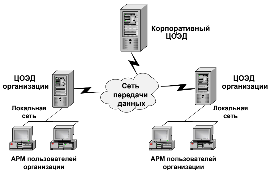
Рис. 4. Схема функционирования автоматизированной системы XML-документооборота
