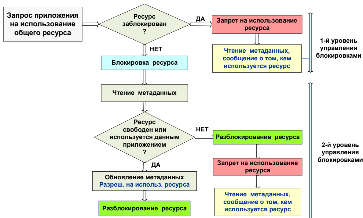
Рис.15. Блок-схема выполнения запроса на использование модуля доставки сообщений
