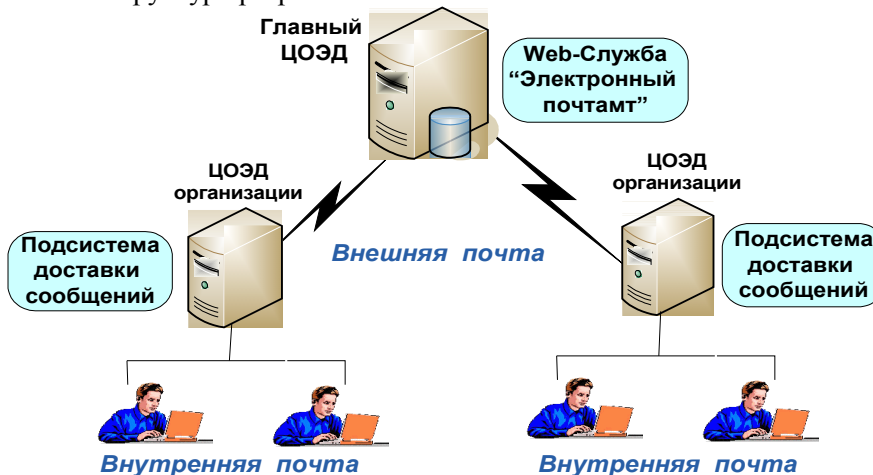
Рис.8. Структура системы экспресс-доставки информации
