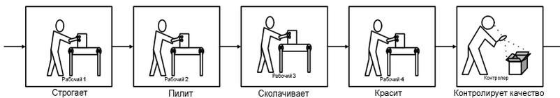
*Рис. 1. Конвейерный процесс производства табуреток.*
