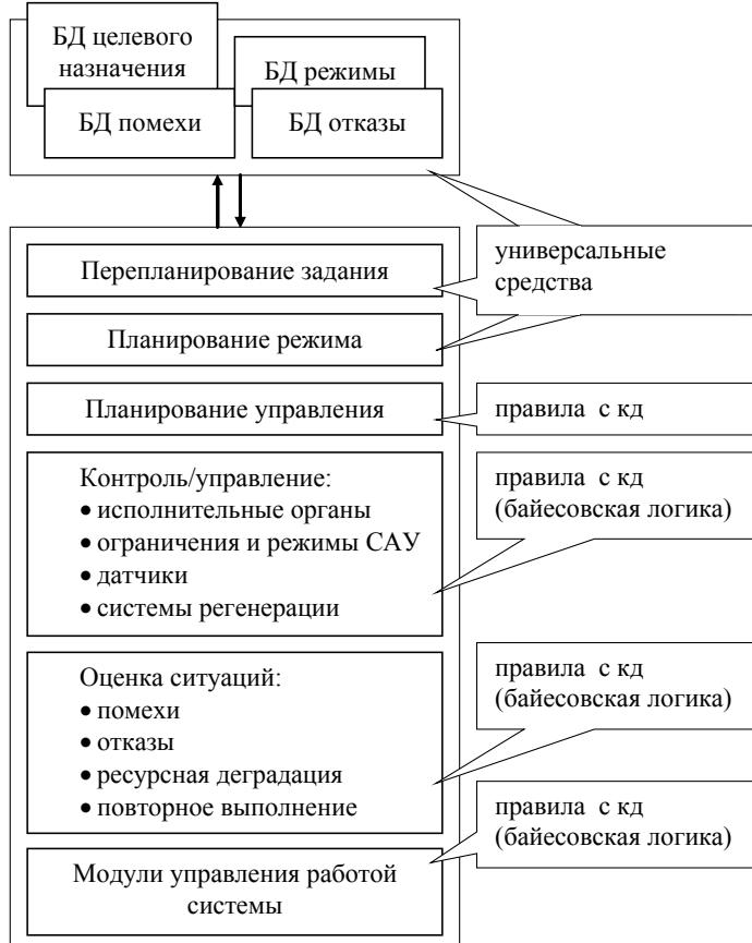
*Рис. 3. Модули экспертной системы руководства функционированием объекта и средства их реализации*
