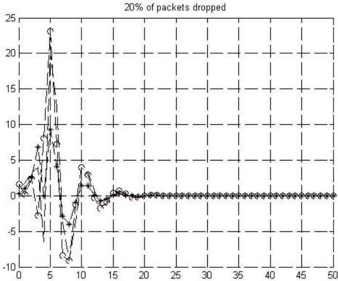
Рис. 4. Переходные процессы при вероятности потери пакета равной 0,2.
