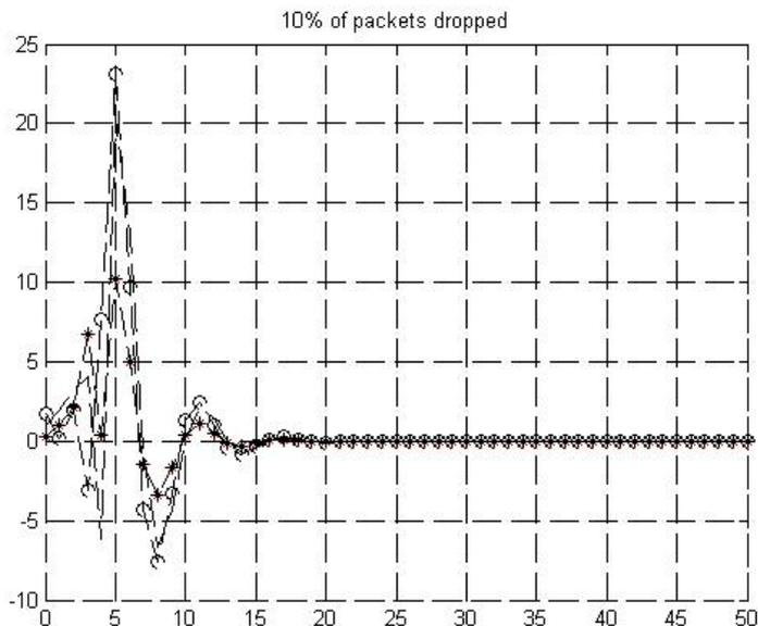
Рис. 3. Переходные процессы при вероятности потери пакета равной 0,1.
