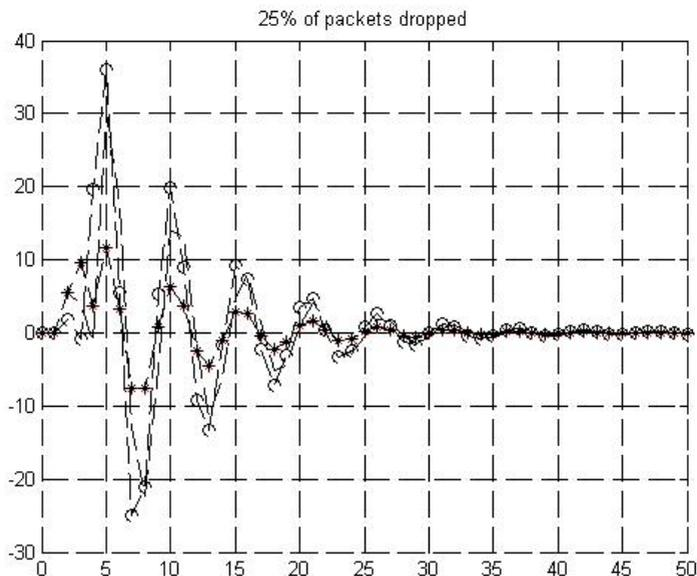
Рис. 5. Переходные процессы при вероятности потери пакета равной 0,25.
