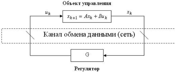
Рис. 1. Схема сетевой системы управления.
