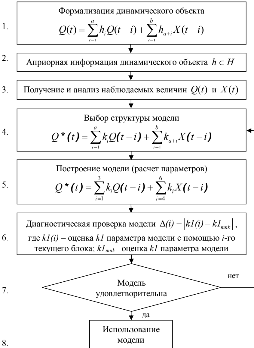
Рис. 4. Блок-схема модифицированного алгоритма идентификации динамического объекта.
