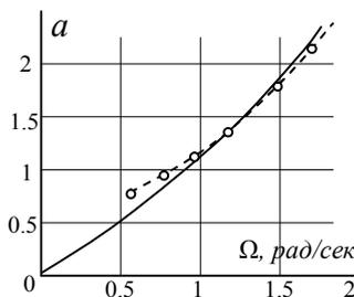
Рис. 4. Пример. Границы возбуждения (сплошная – расчет, прерывистая – эксперимент)
