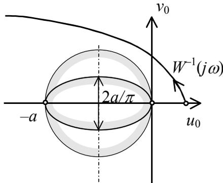
Рис. 7. Огибающая передаточных функций параметра, ограниченного по амплитуде
