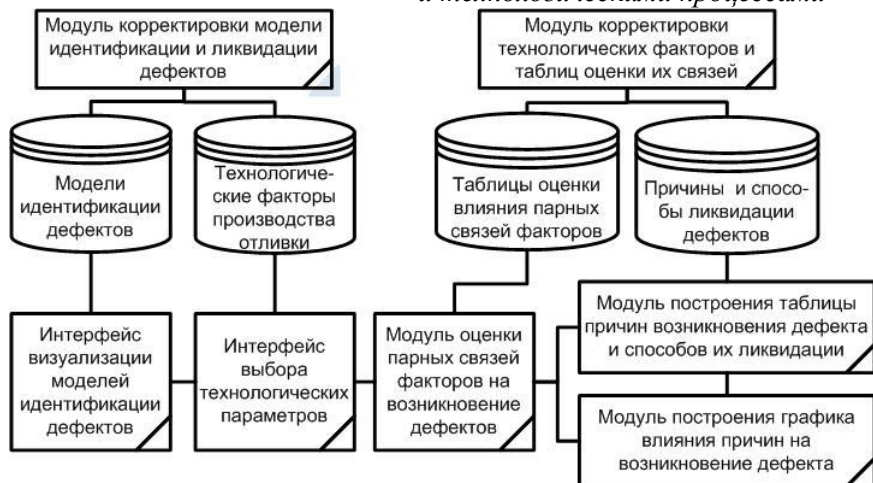
Рис. 6. Архитектура автоматизированной системы распознавания дефектов, причин их возникновения и способов ликвидации на основе прагматических результатов
