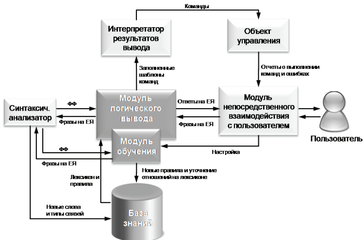
Рис. 6. Схема потоков данных системы Модуль первичного семантического анализа преобразует
