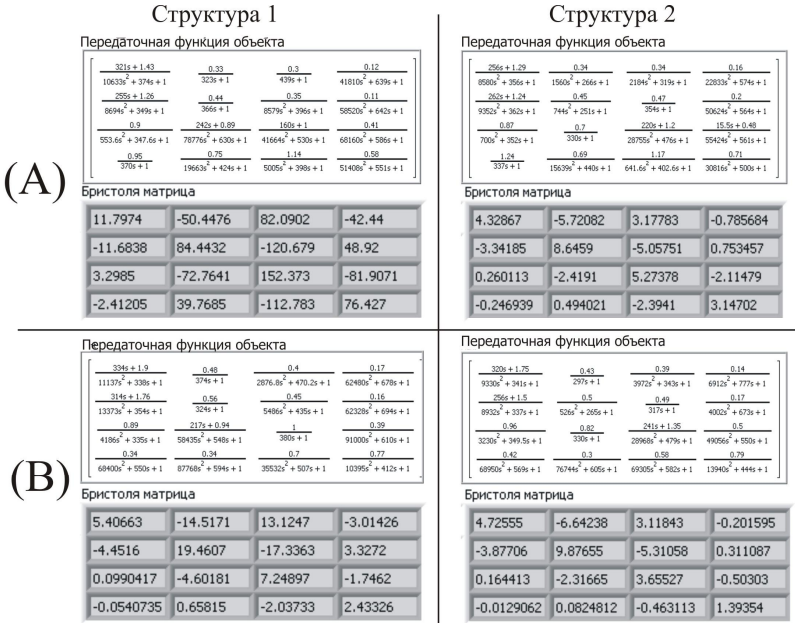
Рис. 3. Передаточные функции объекта и матрицы Бристоля для двух информационных структур системы управления, отличающихся геометрией нагревателей, на начальной (А) и конечной (В) стадиях кристаллизации
