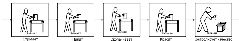
Рис. 1. Конвейерный процесс производства табуреток
