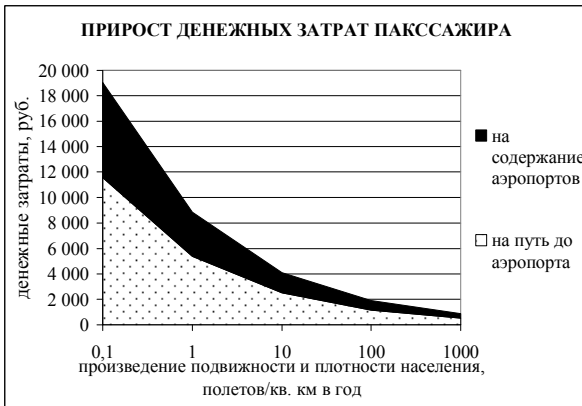
Рис. 3. Зависимость прироста суммарных денежных затрат пассажира от коэффициента подвижности и плотности населения
