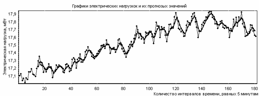
Рис. 6. Результаты прогнозирования активной нагрузки: а – с помощью фильтра Брауна, б – с помощью ИНС, в – с помощью гибридной модели
