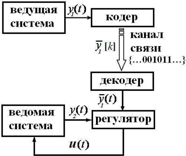
Рис. 1. Структурная схема системы управляемой синхронизации ведомой и ведущей систем. По каналу связи передается выход ведущей системы
