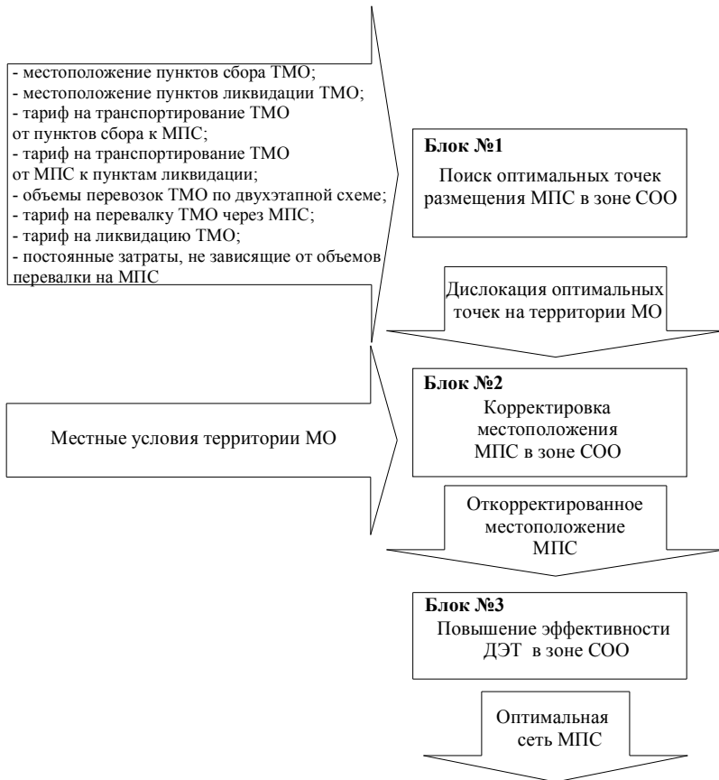
Рис. 2. Блок-схема модели формирования системы двухэтапного транспортирования ТМО
