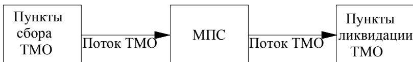
Рис. 1. Схема логистического канала при реализации технологического процесса перевозки ТМО с двухэтапным транспортированием
