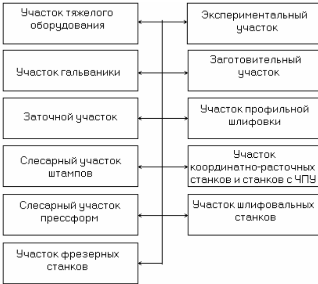
Рис. 1. Структура инструментального производства
