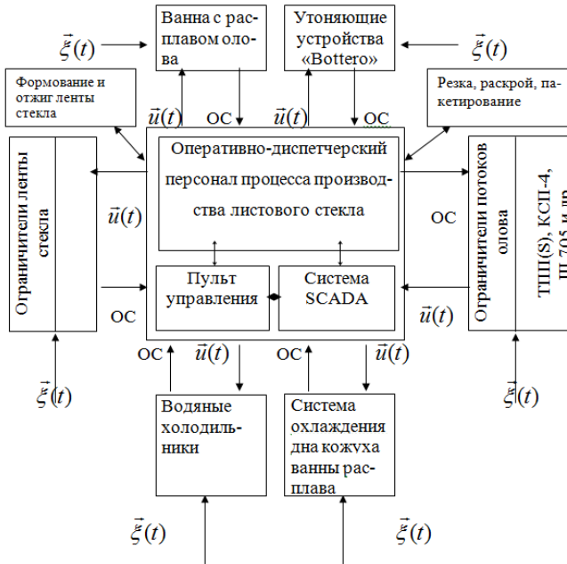
Рис. 1. Структурная схема процесса формования листового стекла как объекта управления ( \bar{u}(t) – управляющие воздействия; ОС – обратная связь; \bar{\xi}(t) – возмущения)
