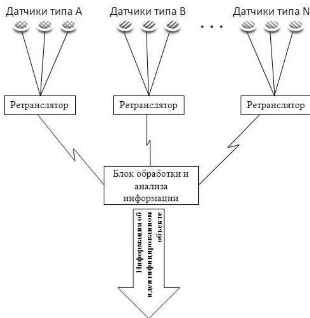
Рис. 1. Обобщенная схема многосенсорной системы обнаружения объектов
