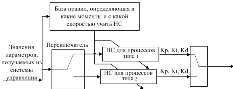
Рис. 2. Разработанная функциональная схема нейросетевого оптимизатора параметров линейных регуляторов
