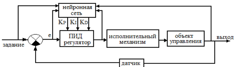
Рис. 1. Схема управления с нейросетевым оптимизатором параметров регулятора
