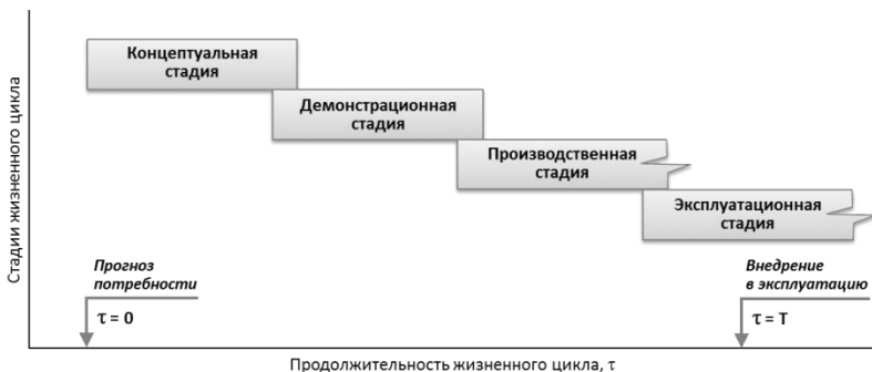
Рис. 1. Жизненный цикл создания уникального объекта
