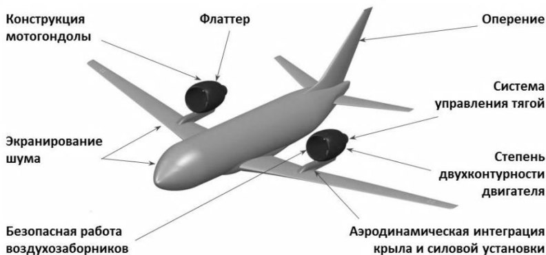
Рис. 19. Ключевые элементы в расчётной концепции самолета
