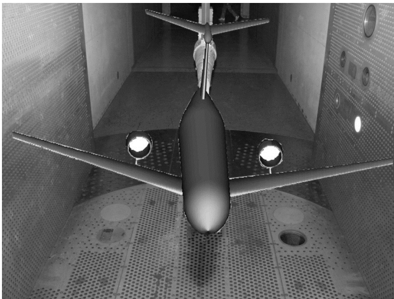
Рис. 22. Валидация технологий. Экспериментальные исследования модели самолета в аэродинамической трубе
