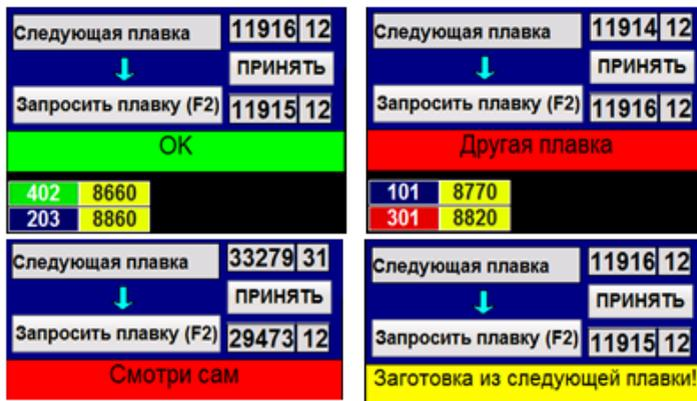
Рис. 14. Визуализация работы системы на посту оператора в SCADA WinCC
