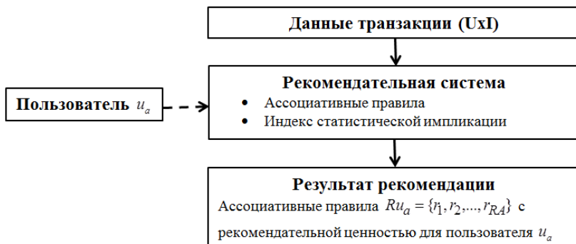
Рис. 2. Процесс работы рекомендательной модели на основе меры индекса статистической импликации
