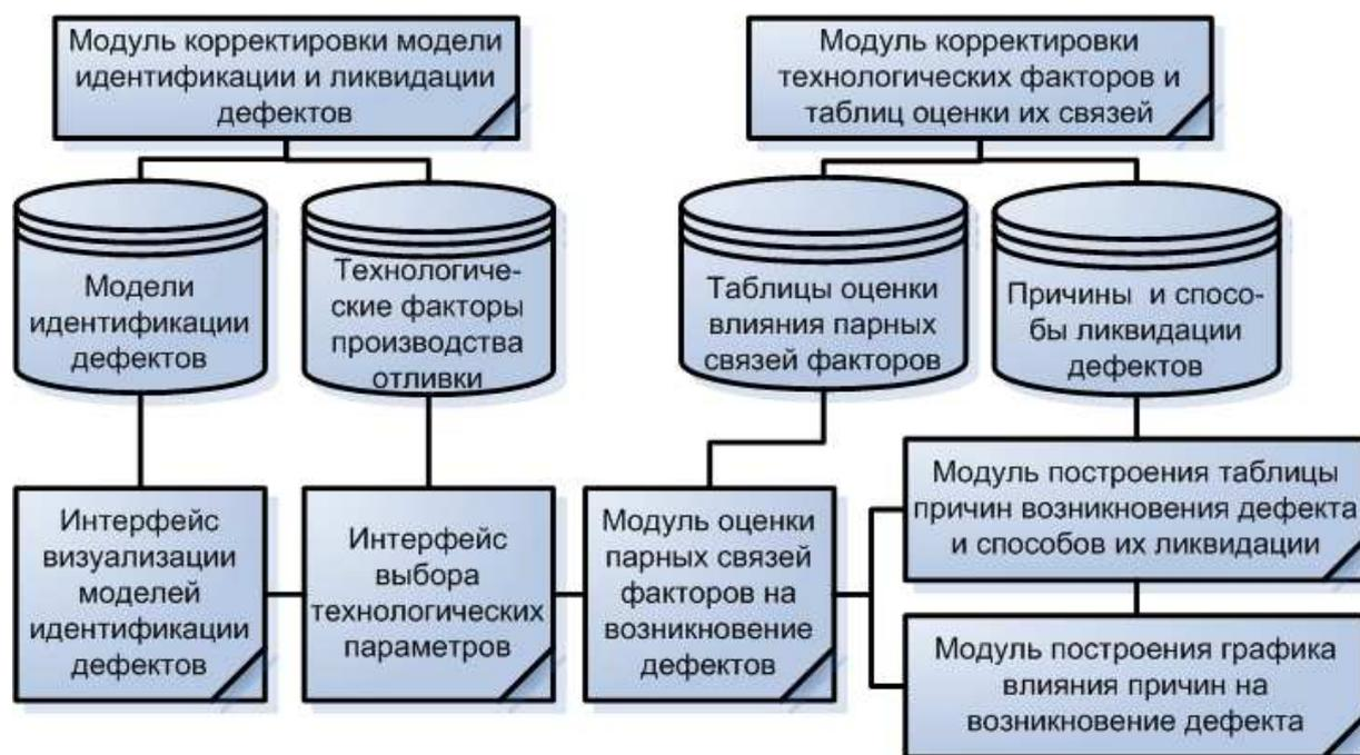
*Рис. 3. Архитектура автоматизированной системы распознавания дефектов, причин их возникновения и способов ликвидации на основе прагматических результатов*
