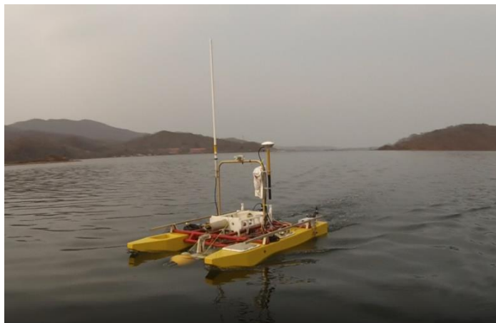
Рис. 10. Комплекс МАРК: АНВА транспортирует АНПА
