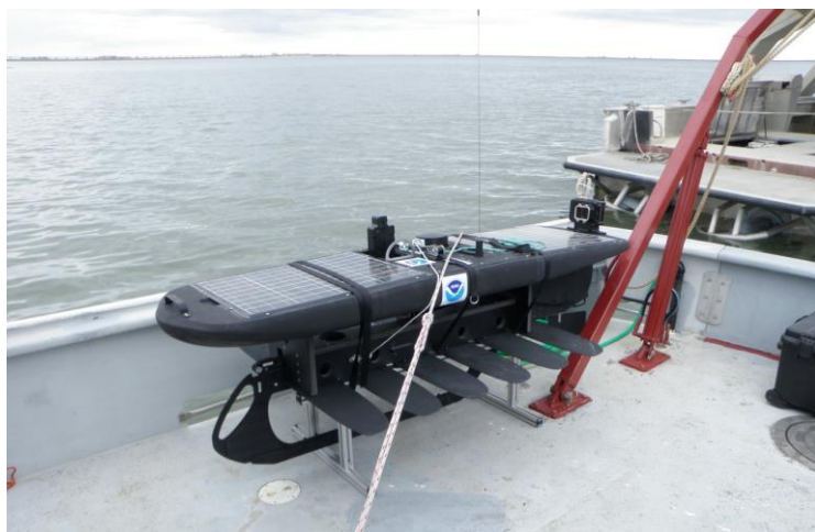
Рис. 8. Волновой глайдер Wave Glider от компании Liquid Robotics
