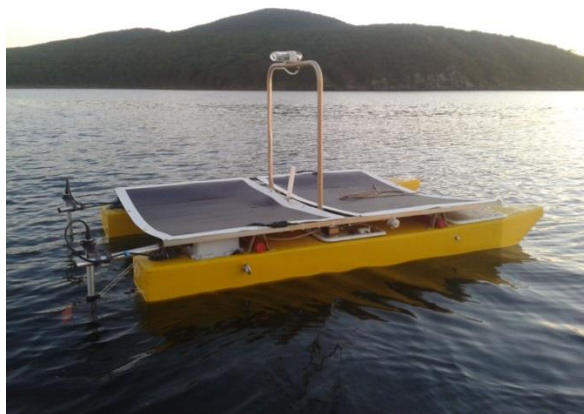
Рис. 11. Комплекс МАРК: АНВА с солнечными панелями
