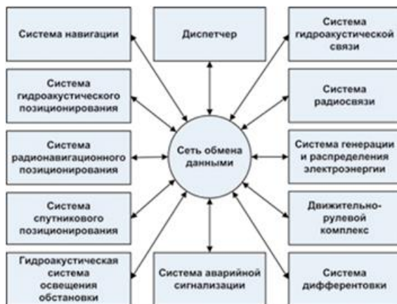
Рис. 1. Схема системы управления АНПА [17]
