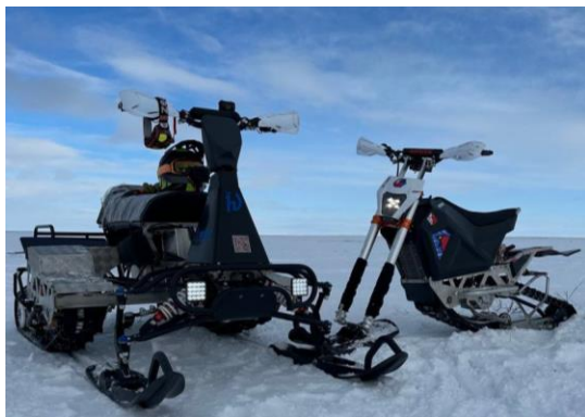
Рис. 1. Опытные образцы: двухколейный «утилитарный» снегоход и одноколейный «снегоцикл»
