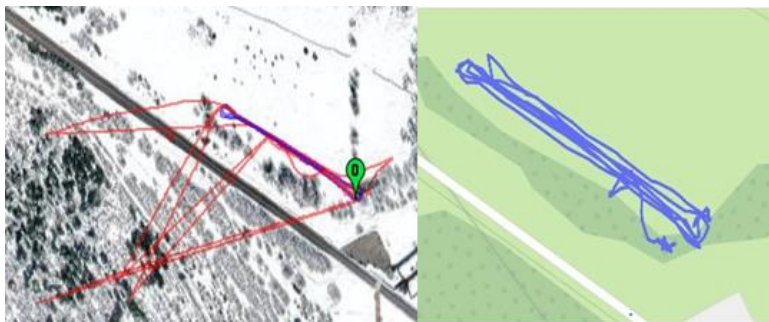
Рис. 8. Повышение точности позиционирования ОТП за счет интеграции данных разных приемников
