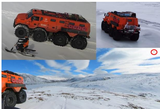
Рис. 3. Пример гетерогенной группы из снегоцикла, транспортного средства повышенной грузоподъемности и БПЛА
