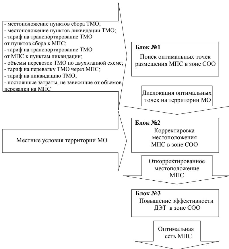
Рис. 2. Блок-схема модели формирования системы двухэтапного транспортирования ТМО
