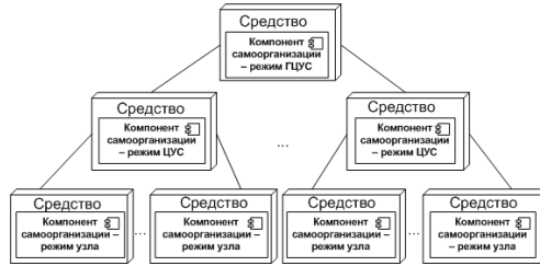
Рис. 4: Схема иерархической самоорганизующейся сети
