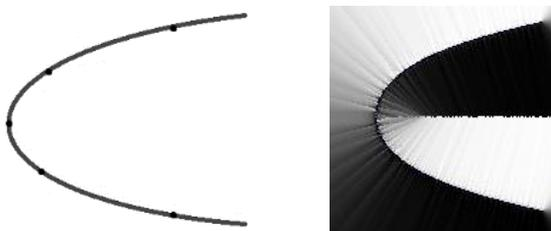
*Рис. 7. Пример моделирования области с помощью кривой Безье*
